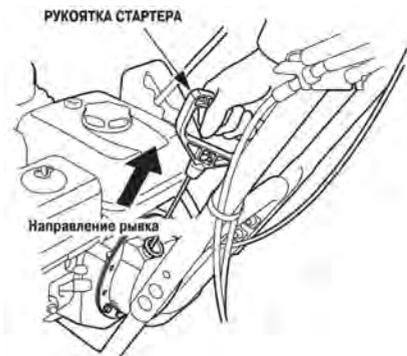
7. После запуска двигателя дождитесь стабилизации частоты вращения. Постепенно переместите рычаг дроссельной заслонки в позицию «Низкие обороты» и прогрейте двигатель до нормальной рабочей температуры.
