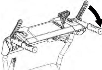
6. Чтобы прекратить очистку снега отпустите рычаг привода шнека. Чтобы остановить машину отпустите рычаг сцепления ходового механизма.
