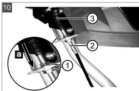
10) Окончательную регулировку натяжения троса проводят с помощью регулировочного винта (3). Ослабьте стопорную гайку (2), прилегающую к регулировочному винту. Поверните регулировочный винт, чтобы удлинить или сократить длину троса. Убедитесь, что трос слегка натянут и не провисает (Рис. 11)
