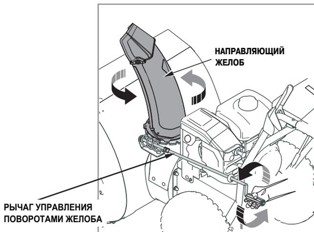
Регулировка угла отбрасывания снега осуществляется вручную посредством поднятия или опускания козырька направляющего желоба. Чтобы зафиксировать угол подъема козырька воспользуйтесь пластиковой барашковой гайкой, расположенной на козырьке.
