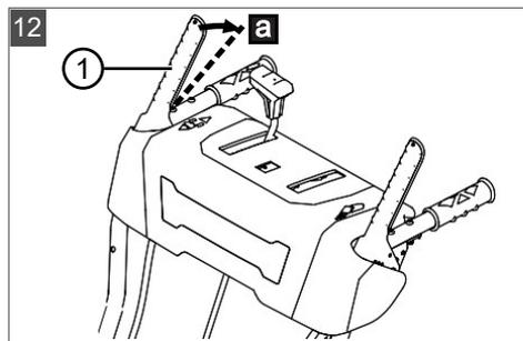
11) Трос управления приводом колёс со временем удлиняется. Если при нажатии рычага сцепления ходового механизма (1) (рис.12) привод колёс перестал включаться (при работающем двигателе), значит трос стал слишком длинным и его необходимо подтянуть.
