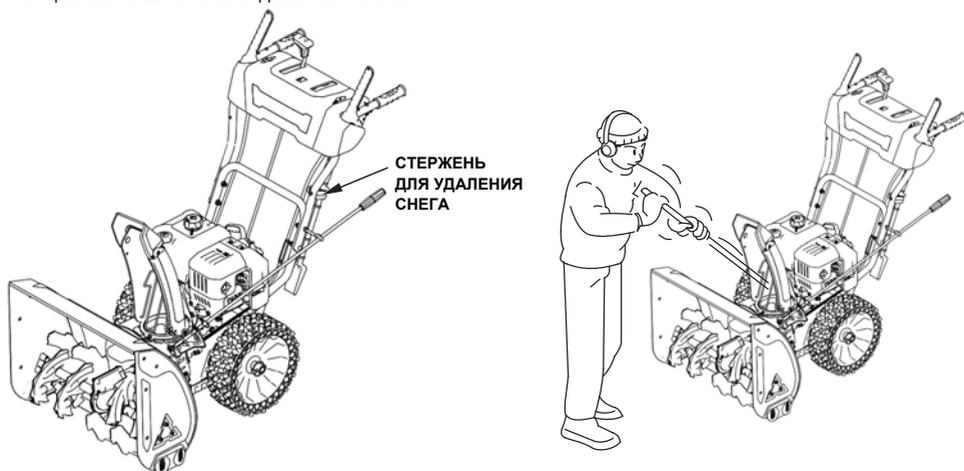
2. После очистки от снега, установите штангу на корпус захвата (в специальные крепления).
