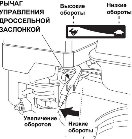
4. Переведите рычаг дроссельной заслонки из положения «Низкие обороты» двигателя примерно на 1/3 в сторону положения «Высокие обороты».
