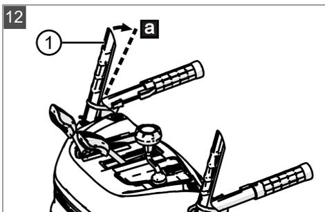
11) Трос управления приводом колёс со временем удлиняется. Если при нажатии рычага сцепления ходового механизма (1) привод колёс перестал включаться (при работающем двигателе), значит трос стал слишком длинным и его необходимо подтянуть.
