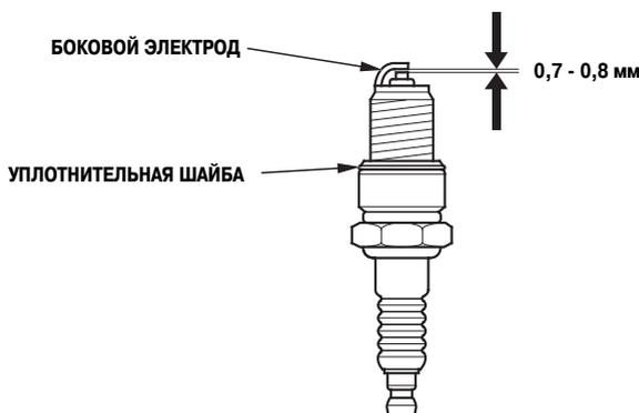
5. Убедитесь в исправности уплотнительной шайбы свечи зажигания и закрутите свечу от руки во избежание перекоса.
