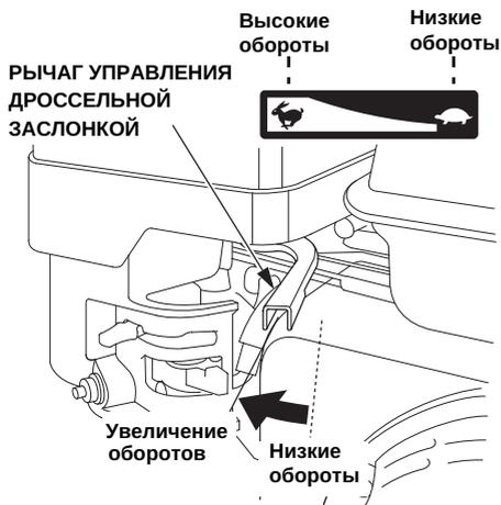
4. Переведите рычаг дроссельной заслонки из положения «Низкие обороты» двигателя примерно на 1/3 в сторону положения «Высокие обороты».
