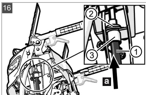
14) Соедините штекерные разъемы (1) проводов для подключения освещения и обогрева ручек. Наденьте изоляционные втулки на штекерные соединения (рис. 17). Закрепите их.
