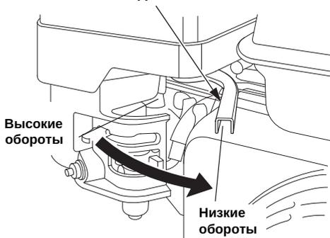
8. Дайте двигателю прогреться несколько минут. Если во время пуска рычаг управления воздушной заслонкой стоял в положении «Закрыто», то по мере прогрева двигателя переведите его в положение «Открыто».
