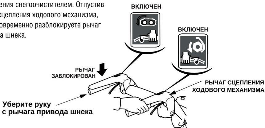
6. Чтобы прекратить очистку снега или остановить машину, отпустите рычаг сцепления ходового механизма
