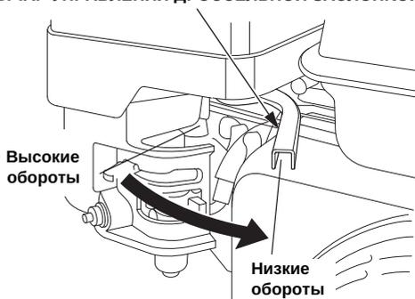
7. Дайте двигателю прогреться несколько минут. Если во время пуска рычаг управления воздушной заслонкой стоял в положении «Закрыто», то по мере прогрева двигателя переведите его в положение «Открыто».
