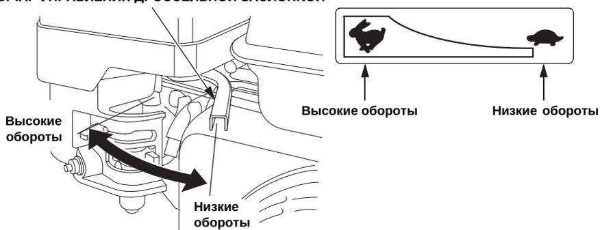
Если вы не уверены в том, что позиция рычага дроссельной заслонки соответствует требуемой частоте вращения и дальности отбрасывания снега, мы рекомендуем установить рычаг в среднее положение. Затем в процессе уборки снега отрегулируйте расстояние, на которое отбрасывается снег.
