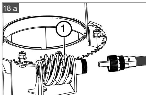
17) Установите трос управления козырьком желоба (Рис. 19), который регулирует угол подъёма козырька для дальности отбрасывания снега.
