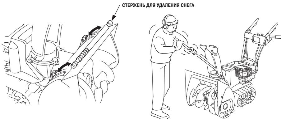
2. После очистки от снега, установите штангу на корпус захвата (в специальные крепления).
