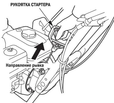
7. После запуска двигателя дождитесь стабилизации частоты вращения. Постепенно переместите рычаг дроссельной заслонки в позицию «Низкие обороты» и прогрейте двигатель до нормальной рабочей температуры.
